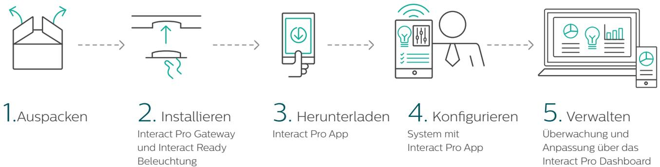
Das kabellose Interact Pro System hilft Ihnen dabei, Sanierungen intelligent und steuerbar zu machen. Über ZigBee Funk vernetzen sich die Leuchten und Lampen untereinander, mit einem Interact Pro Gateway kann die komplette Beleuchtungsanlage über App (iOS oder Android) sowie über den Browser gesteuert werden. Ein Monitoring-Zugang für den Installationsbetrieb ermöglicht Fernwartung und Energiemonitoring.
