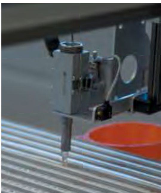
Die smarterion Vergussanlage ermöglicht auch IP65 – IP68-Anwendungen.
