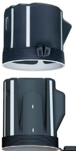
Boîtier d'encastrement LED ThermoX® pour une installation étanche à l'air de luminaires à encastrer LED rigides et orientables dans différentes constructions de plafonds. Le boîtier protège le matériau environnant (film pare-vapeur, isolant, etc.) des températures de service élevées ainsi que le luminaire LED lui-même contre la salissure et crée un joint étanche à l'air.
