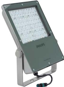
Projecteur LED compact et plat avec une très haute efficacité allant jusqu'à 133 lm/W. Remplacement 1:1 des installations de lampes à décharge classiques. Faible consommation électrique et installation simple avec le connecteur électrique externe (IP68). Boîtier en aluminium moulé sous pression, laqué gris (similaire à RAL 9007 mat). Avec module de commande électronique commutable et étrier de montage. Résistance aux chocs IK08. Marquage ENEC.
