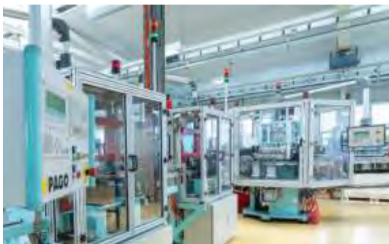
In einer voll automatisierten Produktionsanlage in Bubikon (Schweiz) fertigt R&M seit 20 Jahren Kat. 6 Module für die Anschlüsse von Datennetzen.
