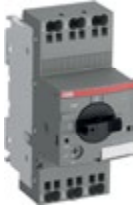
Motorschuttschalter MS132..K Bis zu 32 A, 15kW 400 V AC-3 Ics bis 100 kA
